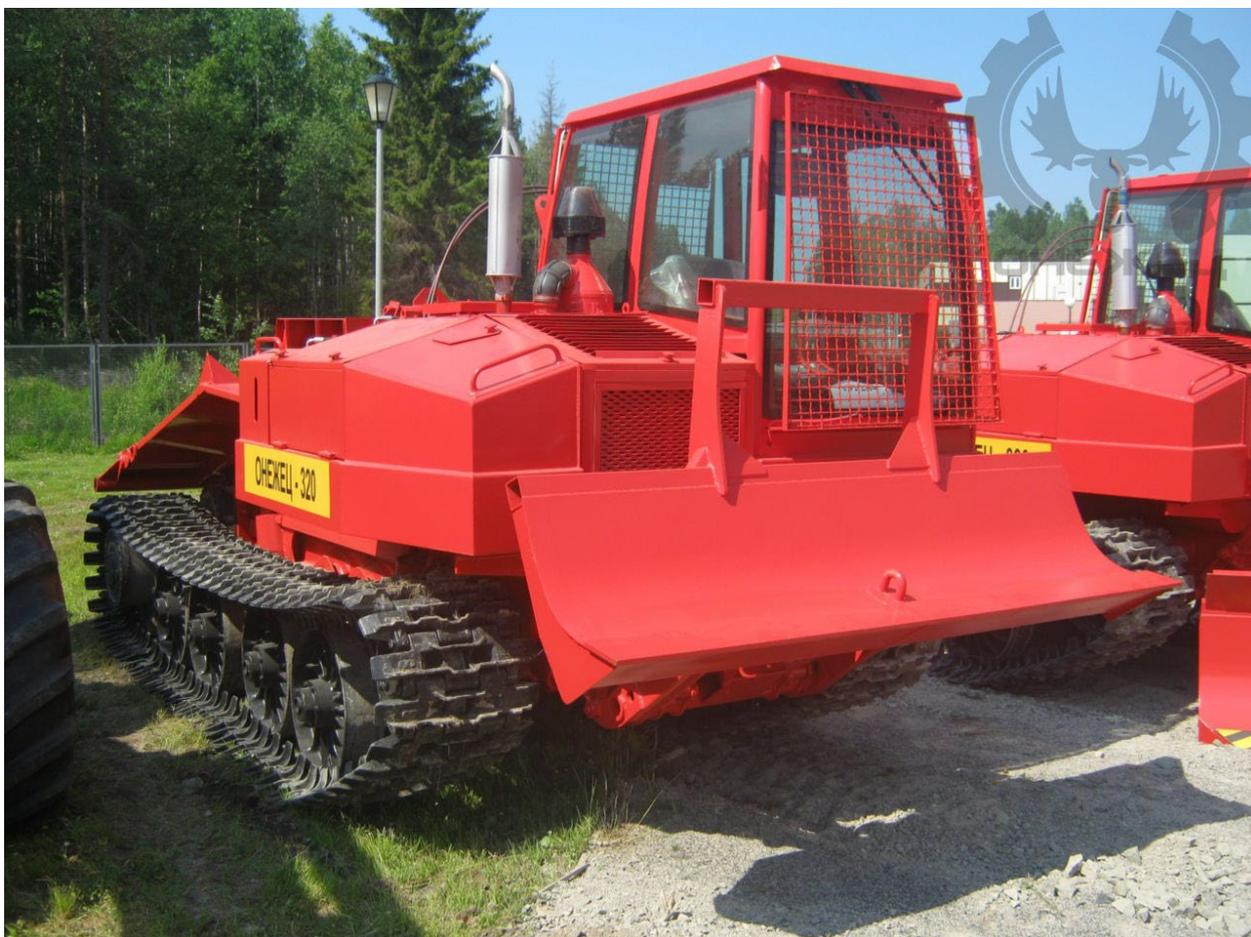
Способен выполнять подготовительные работы, касающиеся волоков, погрузочных площадок. Широко применяется в ремонтных работах по обустройству усов и дорог. Также используется при окучивании пачек деревьев. Универсален в своем роде, имеет широкий функциональный диапазон.
