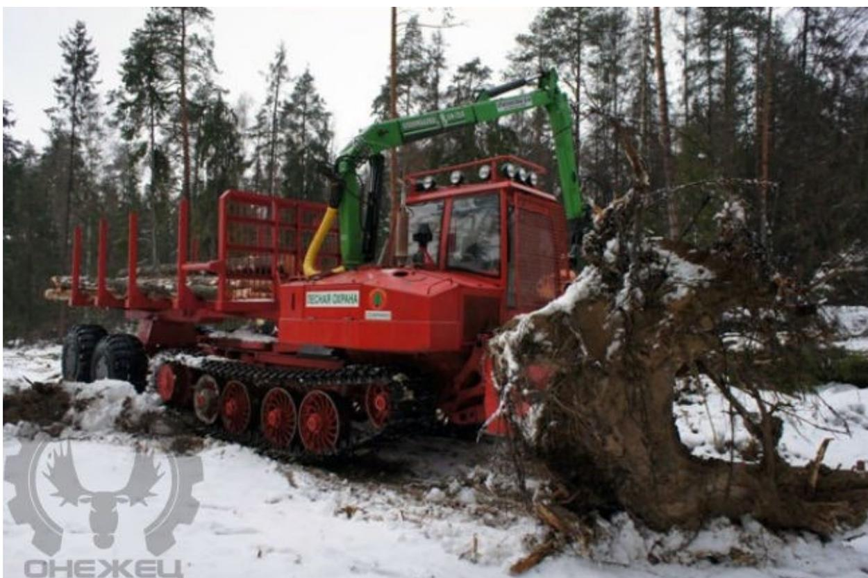
Конструктивными особенностями машины являются новая кабина и рама усиленного типа. Ее ходовая система отличается повышенной проходимостью и имеет более широкие гусеницы, а также бортовые редукторы планетарного типа с ведущими колесами больших размеров, которые приближены к опорной поверхности.
