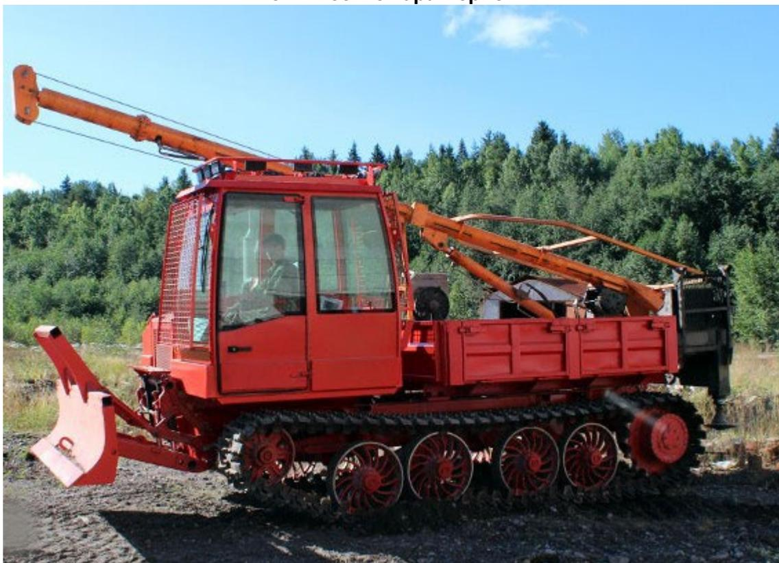
«Онежец-395» оснащен, как и базовая модель усиленной рамой сварного типа из швеллеров с буксировочным крюком. Ходовая система из 4 опорных катков и направляющего переднего и заднего ведущего колеса отлично себя зарекомендовала в условиях европейской тайги и тундры.
