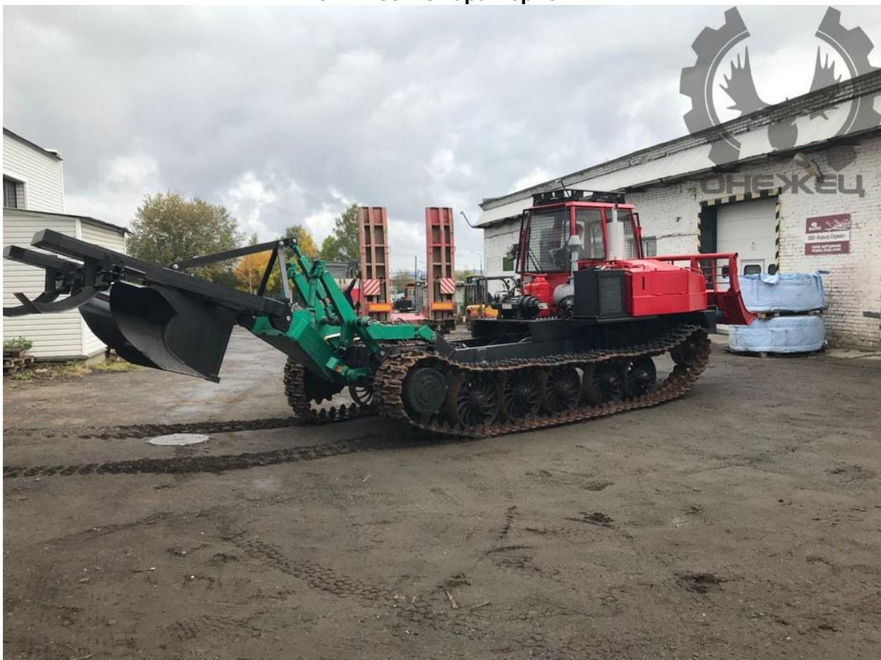
Лесопромышленный трактор «Онежец-400» относится к четвертому тяговому классу, что подразумевает использование в достаточно трудоемких и энергоемких задачах. Данная техника имеет очень широкий спектр применения: установка сварочных агрегатов, лесопогрузочного и бурового оборудования. Шасси трактора лишено платформы для транспортировки хлыстов, а также отсутствует лебедка. Снаряженный вес равен 14,4 тону.
