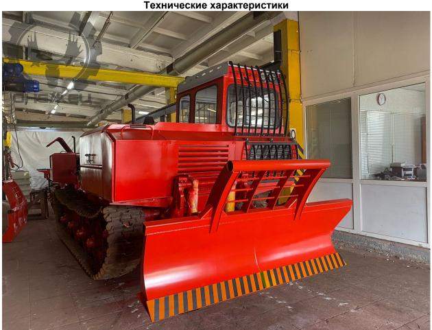
Модель гусеничного лесохозяйственного трактора ЛХТ-100 является усовершенствованной версией <u>ЛХТ-55</u>. В частности, новое поколение оборудуется более технологичными модернизированными системами и может похвастаться более мощным силовым агрегатом СМД 18БН. Другие значимые изменения:
