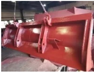
Толкатель 55-68-сб.3 в сб. с ножом ТДТ-55
