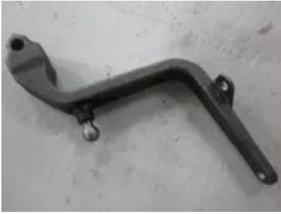
Рычаг 100Б-2904010/-01 (PM3) универсальный
