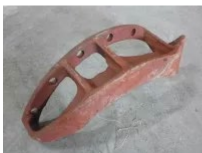
Заталкиватель 55М-15-сб.100 (левый) ТЛТ-100
