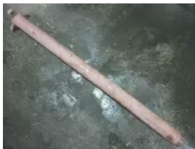
Труба 55-4501161 барабана лебедки
